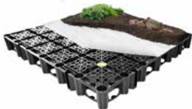
Contec.retention Optigrün Drossel WRB 80F (Gründach extensiv) Wasserspeicher: max. 80 l/m 2 + 3.5 l/cm Substrat
